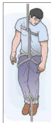
Figura 7-103: Izado con un cabo.
