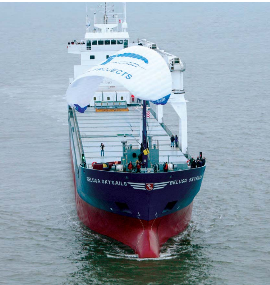
El “Beluga Skysails” con su parapente de 160 m 2 ha realizado ya dos viajes transoceánicos
