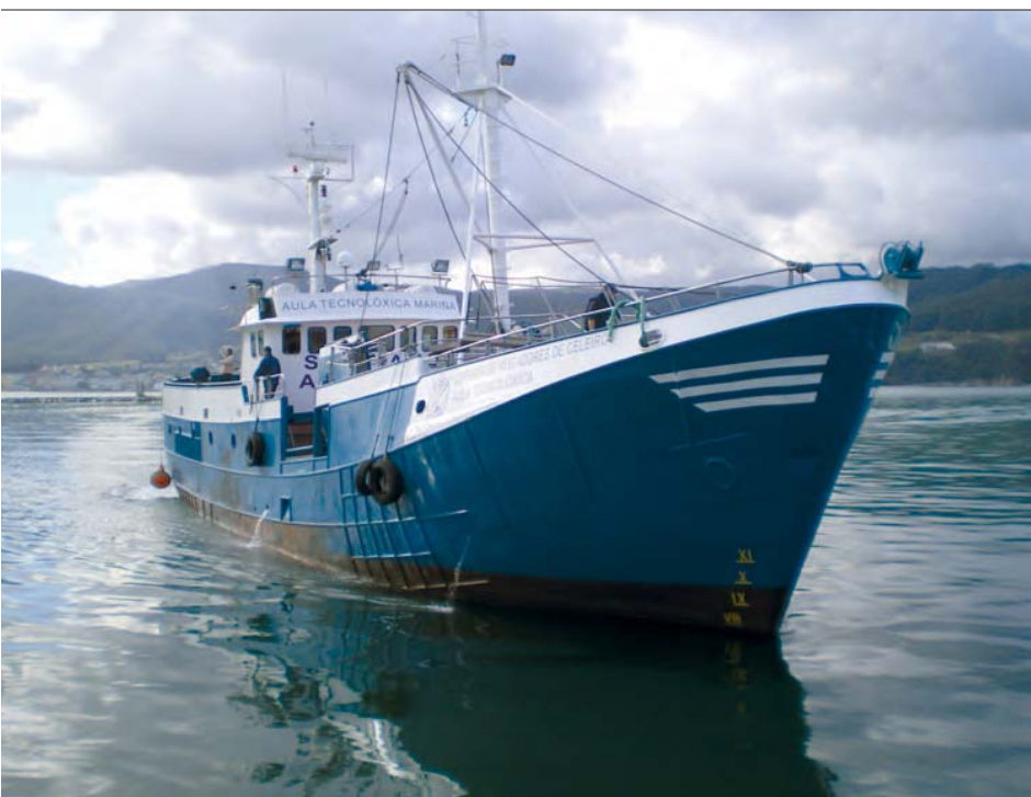
El "Santiago Apostolo" es el barco palangrero utilizado para realizar ensayos sobre el uso de GLP en flota de altura
