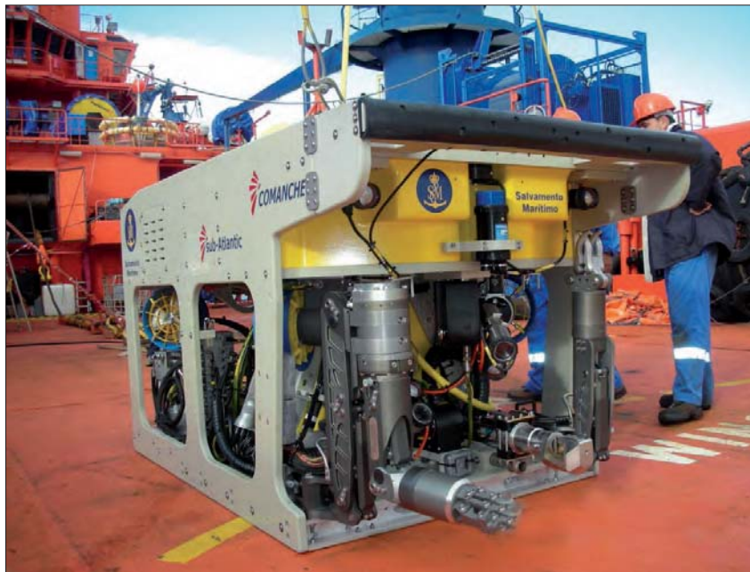
El ROV "Comanche" preparado para usarse en el modo LARS+TMS. En la imagen se aprecian también los manipuladores hidráulicos y las cámaras robotizadas.
