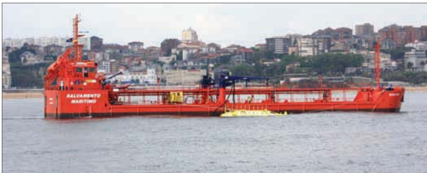
El buque recogedor “Urania Mella” dispone de 10 tanques de 300t de capacidad cada uno, para almacenar los hidrocarburos rescatados del mar. Jesús Navarro
