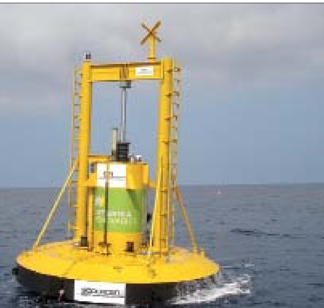
Se instaló en la santonesa playa de Berría, consiste en el sometimiento de un flotador de una boya al movimiento de una bomba hidráulica conectada a un generador de energía.
