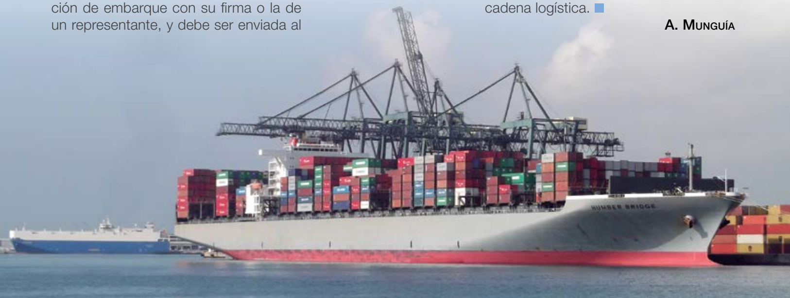
Un pesado incorrecto de los contenedores puede comprometer la estabilidad del buque y, por tanto, la seguridad a bordo.
