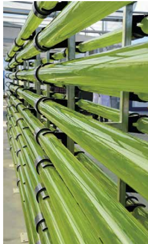
Fotorreactores para cultivo de microalgas en Arcos de la Frontera. AlgaEnergy
