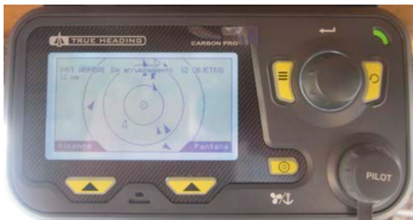
Sistema equipado con AIS, que emplea la banda marina de VHF
