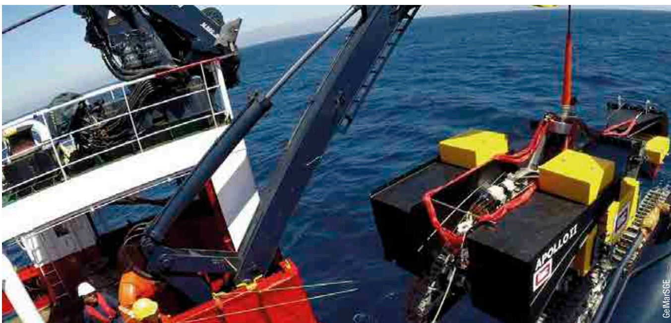
Prototipo de exploración minera submarina Apolo II y sus efectos ambientales. Proyecto UE Blue-Nodules
