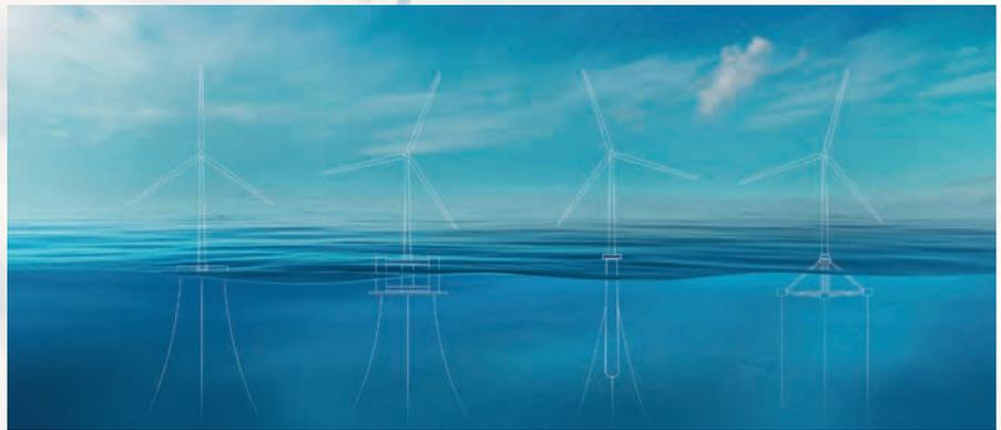
Diferentes tipos de aerogeneradores flotantes.
