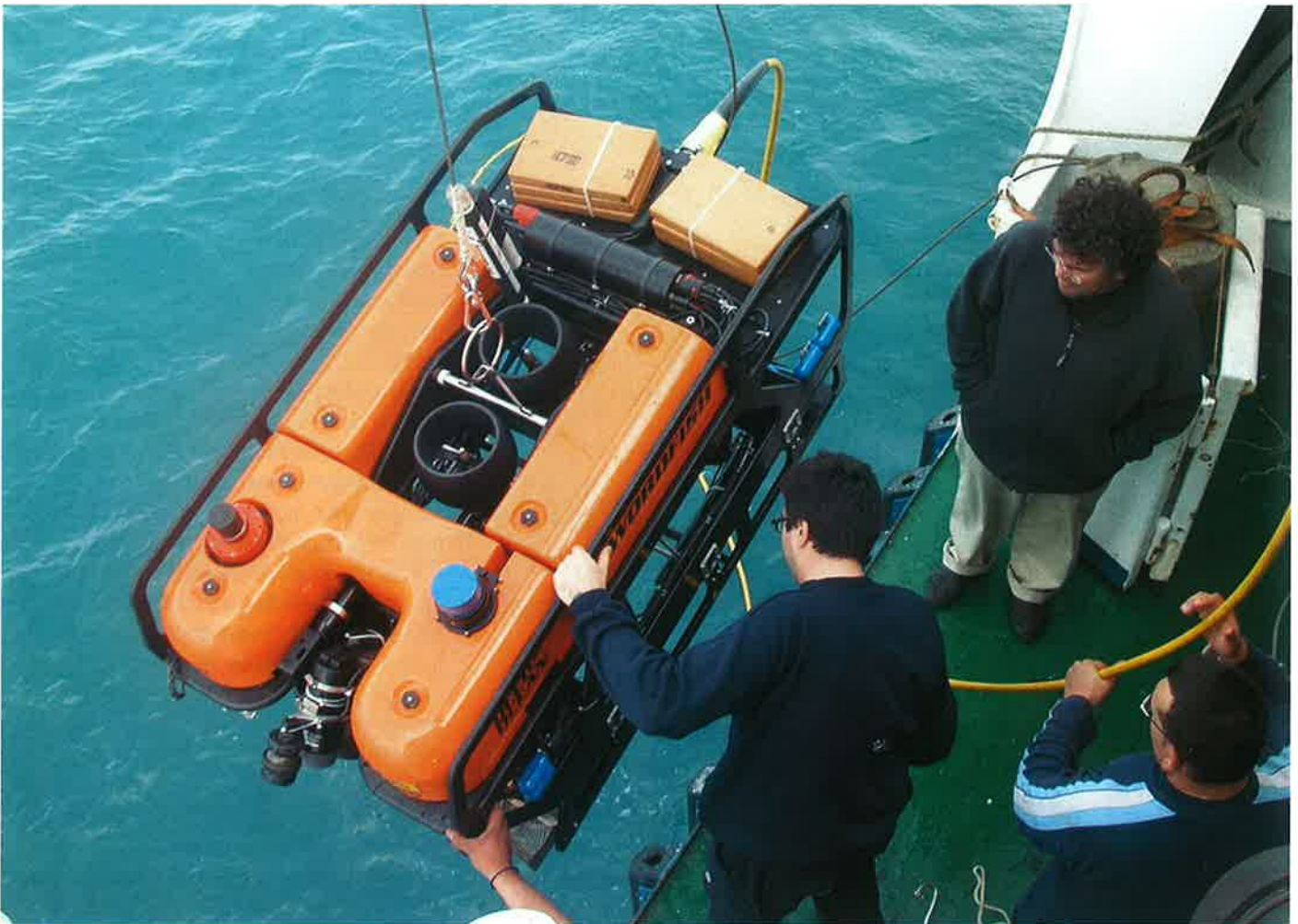
Maniobra de largada del vehículo submarino teleoperado (ROV).
