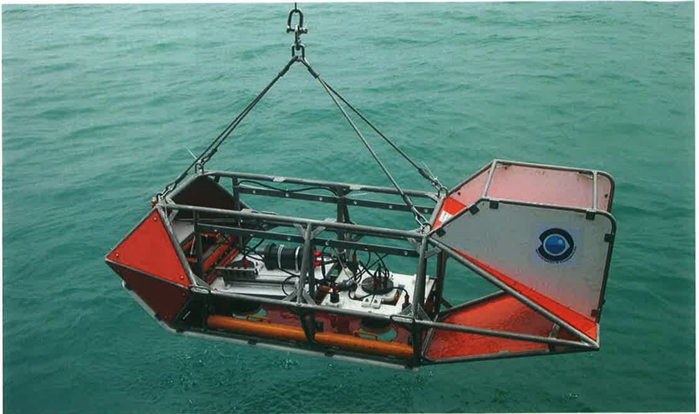
Largada del trineo de fotogrametría desde el Vizconde de Eza.
