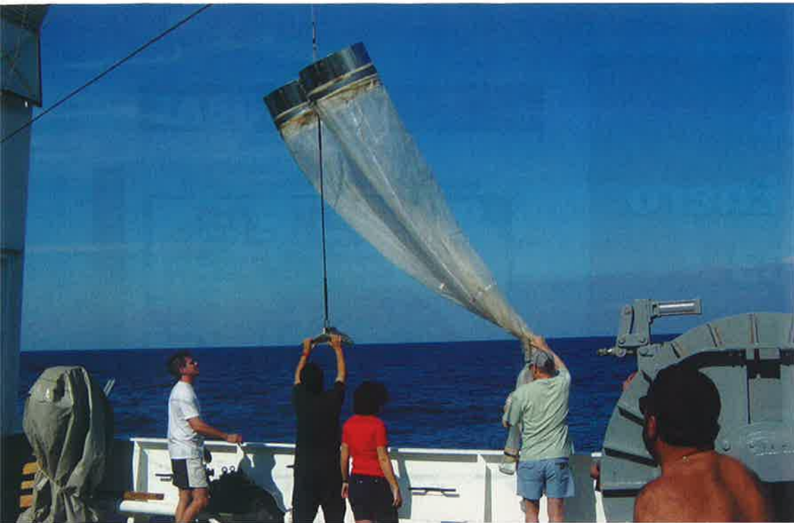
Esta red tiene una malla más amplia que la imagen que abre este reportaje. Se arrastra en superficie y va dirigida a la recogida de muestras de larvas de atún para comprobar su abundancia.
