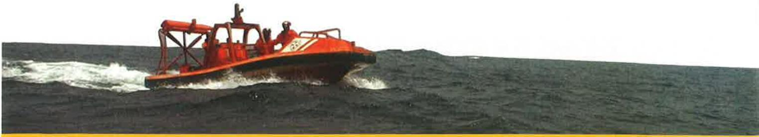
una inspección detallada, retardo al fuego de los materiales, flotabilidad y resistencia a los hidrocarburos. Se someterán a pruebas de caída e impacto. Resistencia y espacio de los asientos. Mecanismo de suelta de los ganchos. Francobordo.
