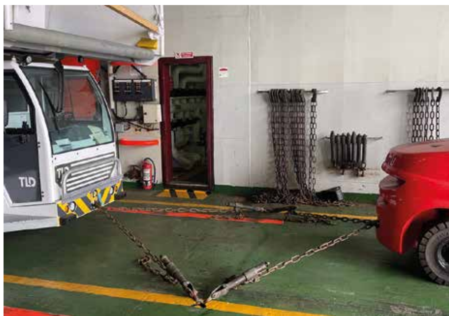
Sistema de anclaje de vehículos en las bodegas de rodado.
