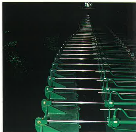
Sistema Multiflap de generación de olas. A la derecha, Gerardo García, maestro de artesanos.
