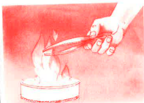
Esterilización de unas pinzas por la técnica de flameado, utilizando alcohol como combustible.
