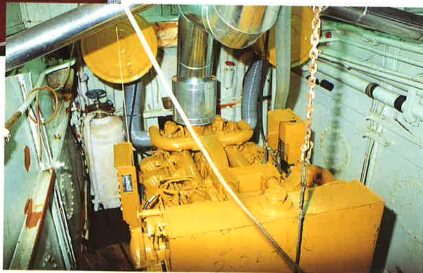
motor marino CAT modelo 3508 775 Hp a 1.600 rpm. - 580 kW - 8 cilindros en V
