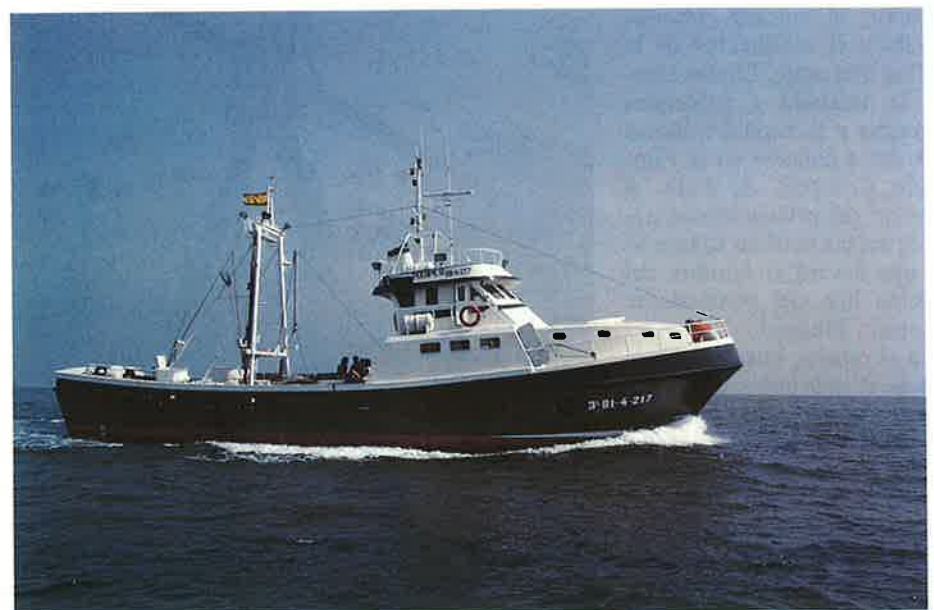
Pesquero nombrado "PIXARE II" de 25 metros de Eslora y 96 de T.R.B., dedicado a la pesca de palangre y fabricado en PRFV.
