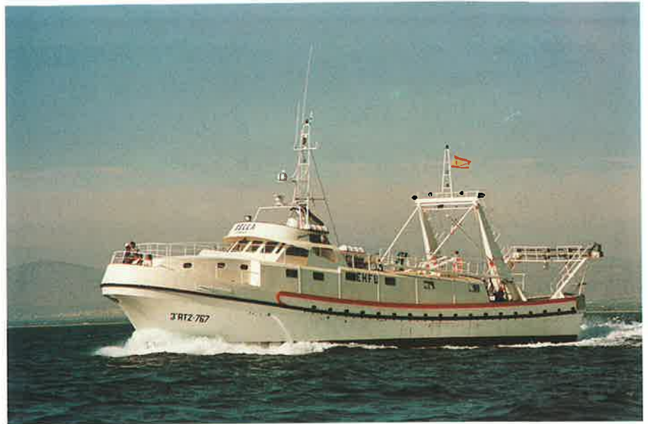
Pesquero nombrado "BELLA" de 7 metros de Eslora y 116 T.R.B., dedicado a la pesca de arrastre y fabricado en PRFV.
