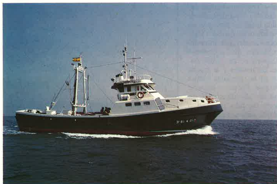
Pesquero nombrado "PIXARE II" de 25 metros de Eslora y 96 de T.R.B., dedicado a la pesca de palangre y fabricado en PRFV.
