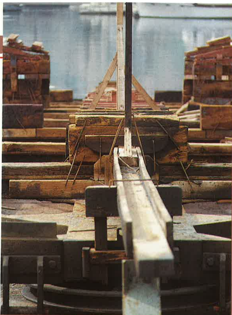
El armazón de los barcos empieza con quilla y cuadernas.
