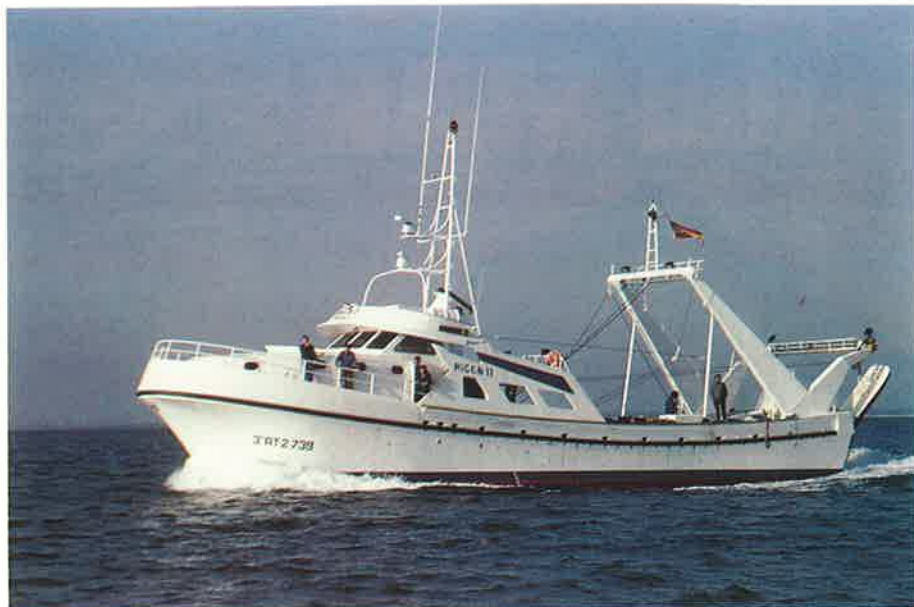
Pesquero nombrado "MIGON II" de 25 metros de Eslora y 99 T.R.B., dedicado a la pesca de arrastre y fabricado en PRFV.
