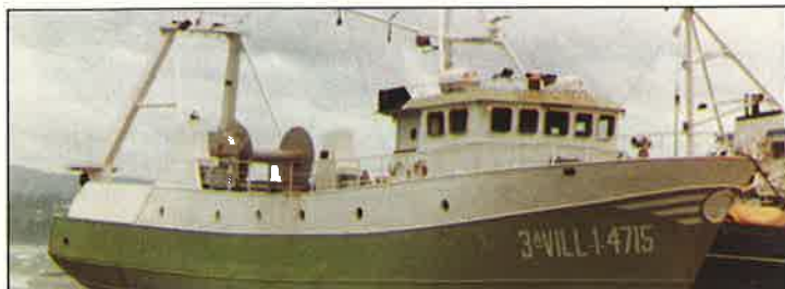
"Santa Uxia" c/ 241 de Astafersa. Pesquero de arrastre por popa de 26,50 mts.
