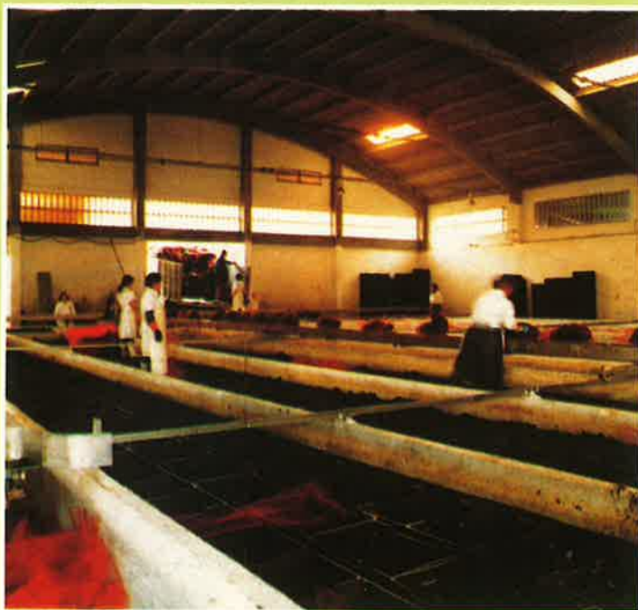
Cascada para decoloración de agua de depuración. Sobre estas líneas, colocación de mejillones en piscinas de depuración.
