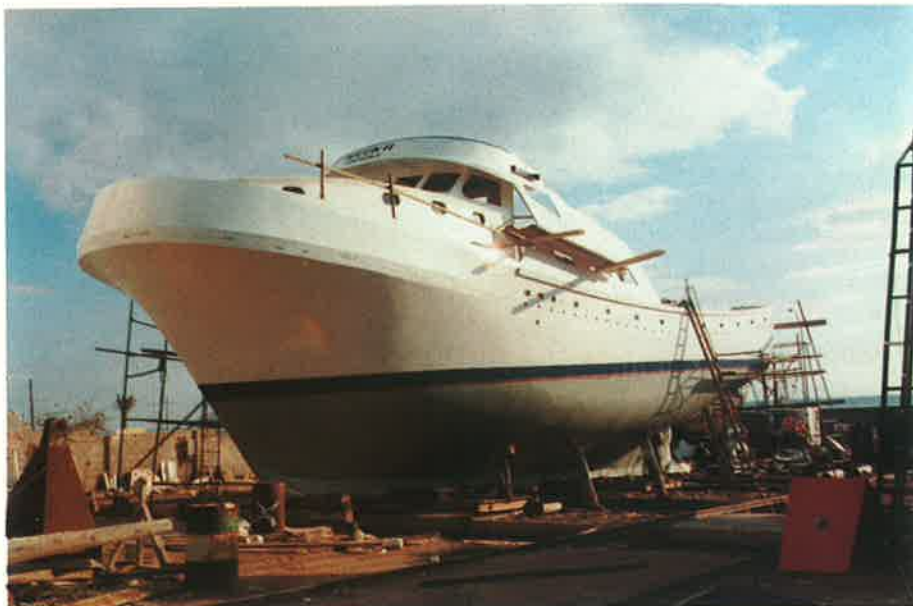
Pesquero en construcción nombrado "MIGON II" de 25 metros de Eslora y 99 T.R.B., para dedicarlo a la pesca de arrastre.
