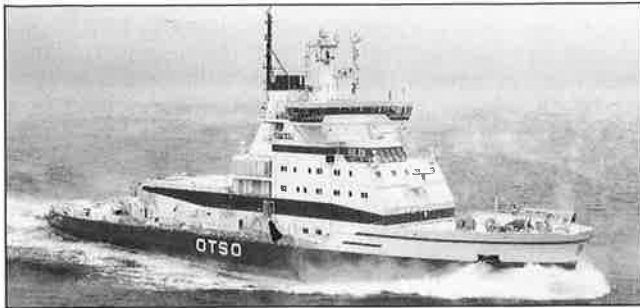
Rompehielos OTSO, propiedad de la Oficina Finlandesa de Navegación, construido en el Astillero Wärtsilä de Finlandia y entregado en 1986. Opera en el Báltico y en el Mar del Norte. Eslora total: 99 m.
