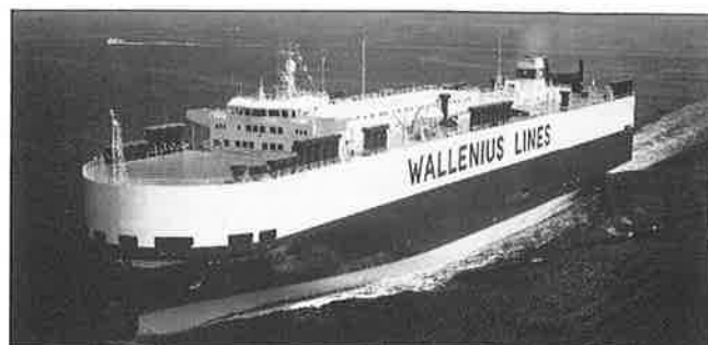
Transporte de coches m/s FALSTAFF, propiedad de Wallenius Shipping Lines AB, Suecia. Construido en el Astillero japonés Hitachi y entregado en 1985. Eslora: 200 mts.
