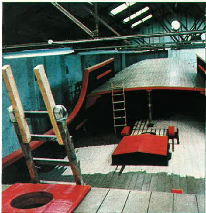
La toldilla y el combés, con su escotillón, desde el castillo. En primer plano, el asiento del palo trinquete. La arboladura se montará en Japón.
