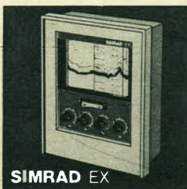
SIMRAD EX Detector de gran sensibilidad para todo tipo de pesca de fondo, arrastre costero y Gran Sole, pincho, volanta, etc. Detecta merluza suelta a más de 200 brazas. Tiene seis escalas hasta 960 brazas. Dynaline, Línea de Contorno y TVG.
