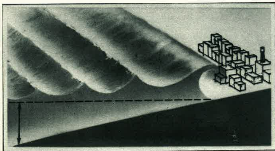
Junto a la costa, en aguas poco profundas, la velocidad de las olas es proporcional a la raíz cuadrada de la profundidad del mar, es decir, disminuye rápidamente. Una ola de medio metro a 500 nudos en alta mar, se convierte en una ola mortífera de 30 m. de altura a 30 nudos en la orilla. Gráfico de NOAA, Washington.
