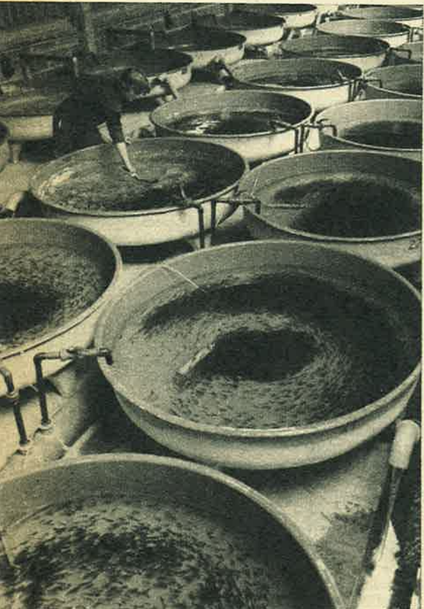
Estantes sobre los que se colocan los tanques de cría de 152 milímetros en que las truchas reciben su primera dosis de oxígeno.
