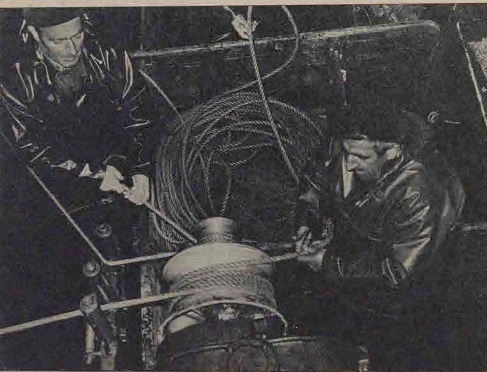
Mediante un juego de grúas y poleas se hala la red...
