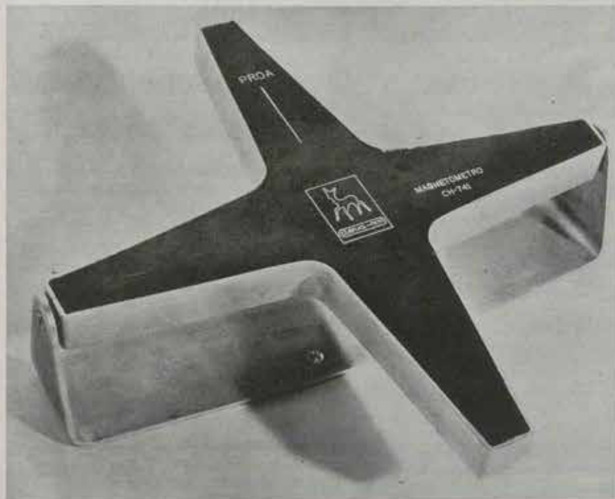
Magnetómetro del piloto automático inventado por Juan de la Cierva.
