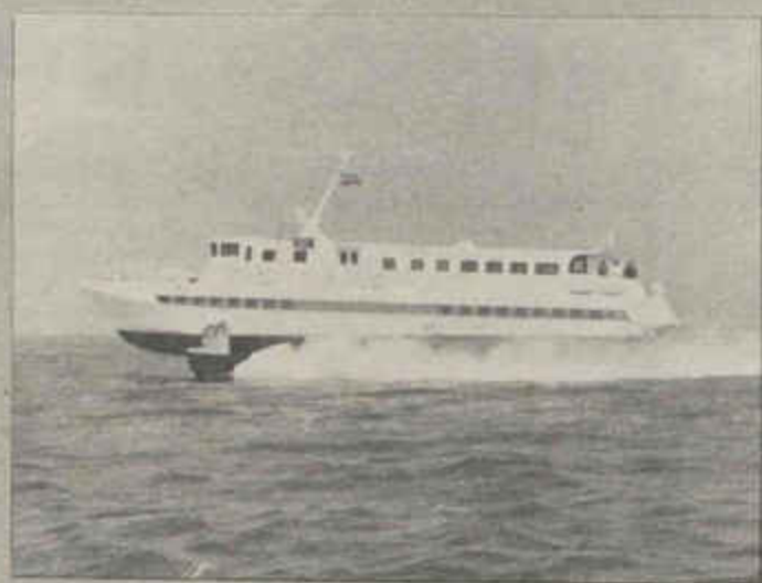
HIDROALA. —De 30 metros de eslora, pesa 78 toneladas. Fue construido por la Vosper Thornycroft Limited en sus astilleros de Portchester, Sur de Inglaterra. Esta embarcación, de aleación de aluminio, alcanza una velocidad de 40 nudos y tiene capacidad para 135 pasajeros.
