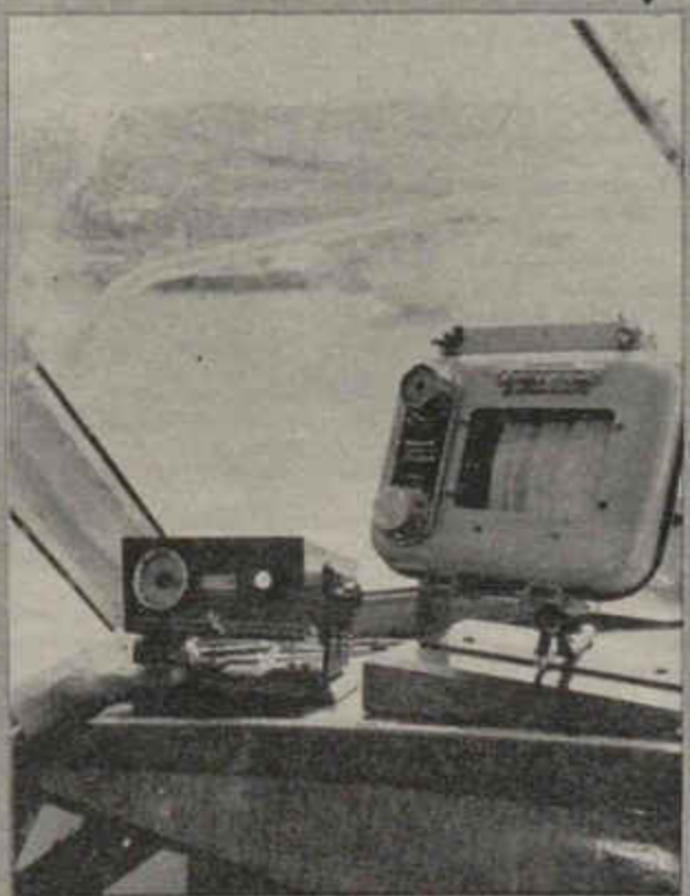
CORREDERA. —Una nueva corredera mide la velocidad de una embarcación y la distancia recorrida desde el interior del casco por el sistema Doppler empleado en los aviones. El modelo está gobernado por dos pequeños transductores unidos al interior del casco, desde donde proporciona lecturas exactas de la velocidad a través de fibra de vidrio, aluminio o acero.
