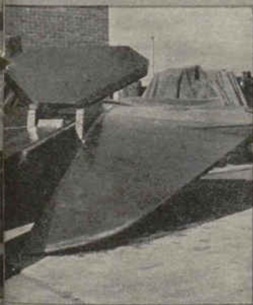
peso. El ancla logra una gran penetración mediante la combinación de unas uñas puntiagudas y huecas, y una presión del 25 por 100 del peso total de la misma sobre éstas. Las superficies de las uñas proporcionan una sujeción de 15 a 35 veces mayor que el peso del ancla.
