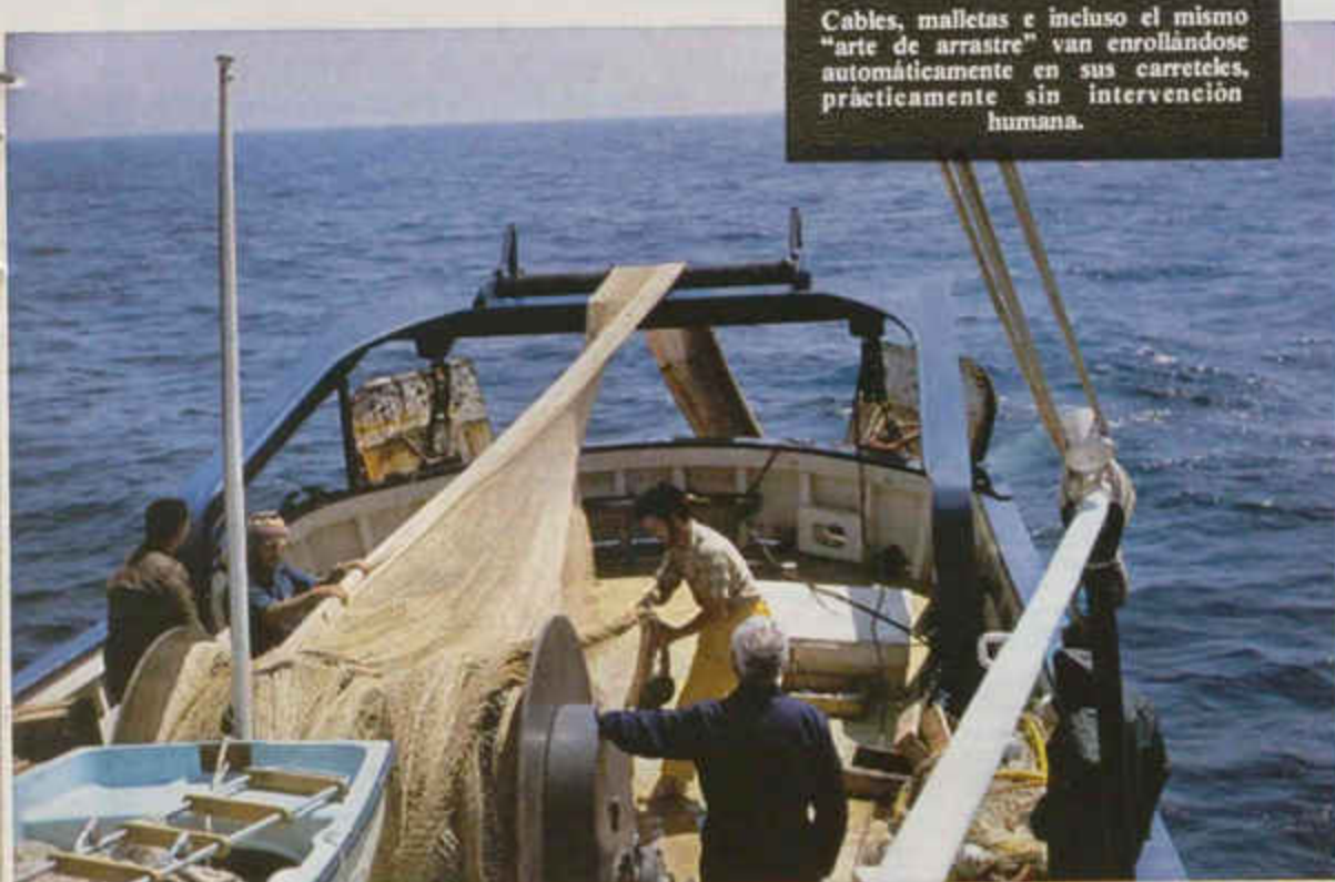
A bordo de "El Pescador". Enganche automático de las "puertas" en la maniobra de virado del arte de arrastre.
