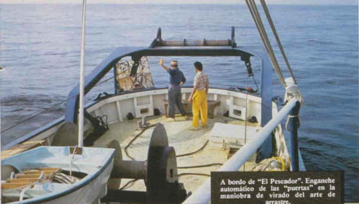
Cables, mallas e incluso el mismo "arte de arrastre" van enrollándose automáticamente en sus carretes, prácticamente sin intervención humana.
